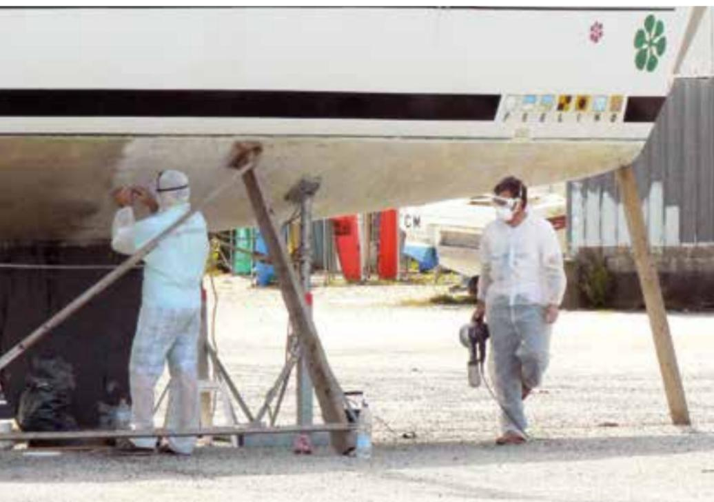
L'application sur les carènes de peintures antifouling (ainsi que des solvants associés) dégage des composants organiques volatiles, notamment lors du ponçage d'une couche d'antifouling, lors de l'utilisation de nettoyeurs haute pression ou lors de la pose de la peinture. Cela peut avoir des conséquences sur la santé.
