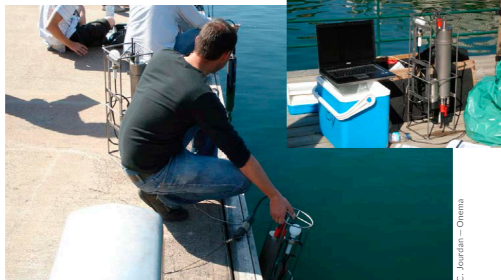
Etalonnage de sonde avant réalisation de mesures sur le Lac Paladru (Isère)
